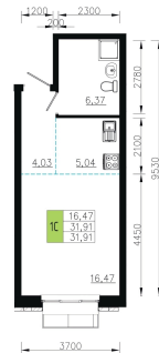
План 2 этажа Корпус 1 Секция 2 квартира №2
