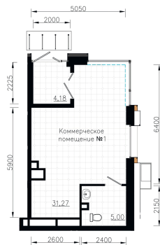
План 1 этажа Корпус 1 Секция 1 коммерческое помещение №1
